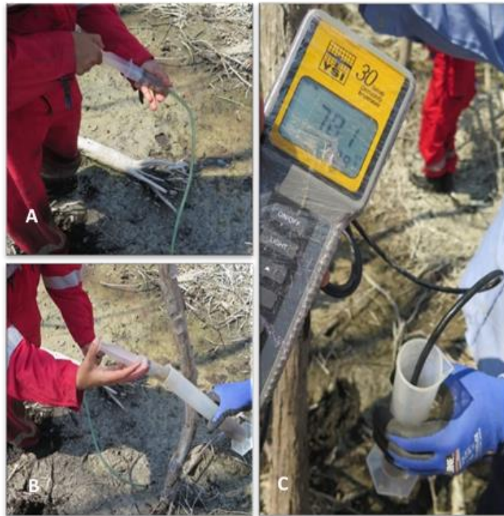
Figura 3.2-5 Medición de parámetros fisicoquímicos in situ. A y B: Colecta de agua intersticial; C: Medición de salinidad. Fotos: Archivo línea RAE, 2018.
