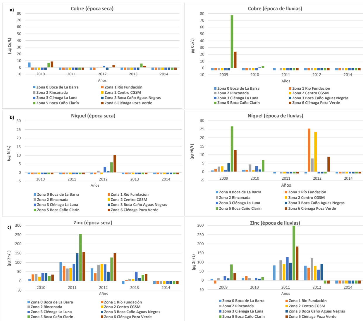
Figura 4.1-29. Histórico de concentración de metales biodisponibles de a) Cobre, b) Níquel y c) Zinc en material particulado suspendido en agua de las seis zonas de monitoreo de la CGSM medidos en época seca: Enero-Junio y época de lluvia: Julio-Diciembre, entre los años 2009 y 2014. Barras por debajo de cero representan valores menores al límite de cuantificación de la técnica analítica.
