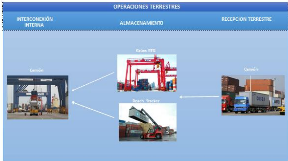
Figura 5.5. Procesos que se realizan en tierra en una terminal de contenedores
