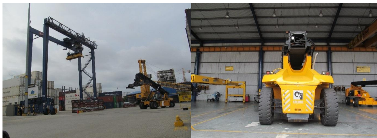
Figura 3.6. Elevadores para cargue y descargue de contenedores en Patios (elevador frontal y de alcance). Fotos: María Escobar.
