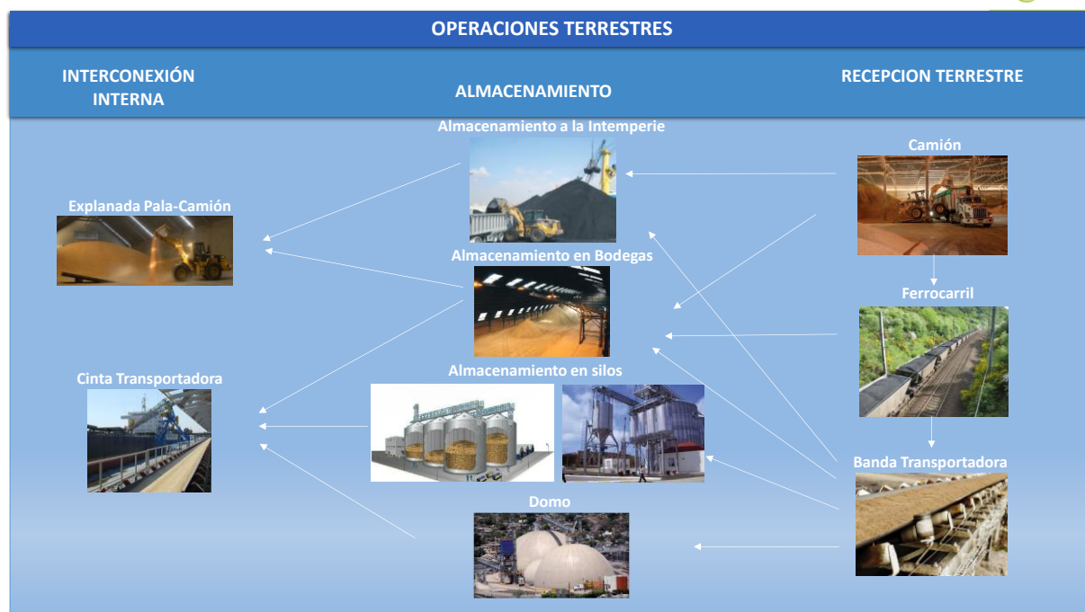
Figura 5.3. Procesos que se realizan en tierra en una terminal de graneles sólidos
